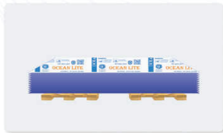
Không đặt tấm trực tiếp xuống nền xi măng
